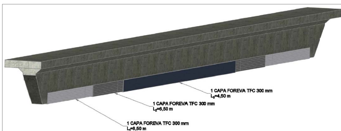
Figura 9. Refuerzo tipo de viga secundaria con TFC.
